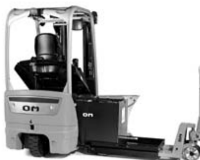
3) Sostituzione batteria con rulliera integrata e transpallet dotato di rulliera
